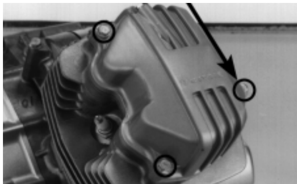
PARAFUSOS DA TAMPA DO CABEÇOTE
