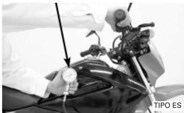
MEDIDOR DE COMPRESSÃO
